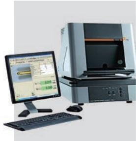
めっき、アルマイト、無電解ニッケルなどムラなく表面加工されているかの確認を社内の測定器で実施。試作段階、また生産ラインに入った製品に関しても、適時精密検査を実施し、常に検品を心掛けることで製品の安定供給を実現しています。
